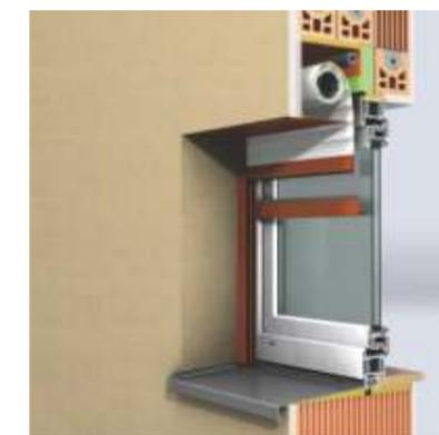
Außen-Unterputz-Rollladen mit 90° Rollladenkasten und Insektenschutz-Rollo
